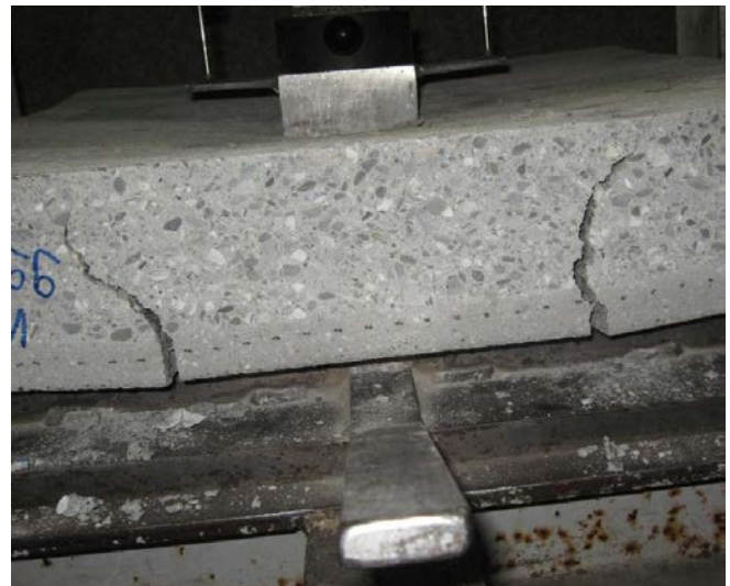
Bild 7: Prüfling VHS im Bruchzustand
