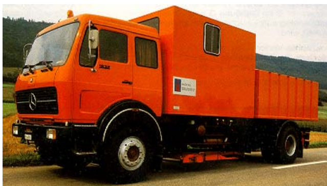
Bilder 7/8: Lacroix Messwagen und Messbalken in Aufnahmestellung
